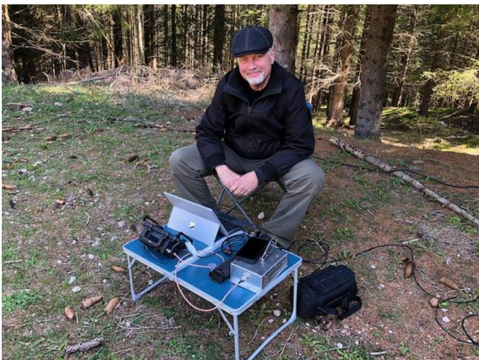
Per la stazione in digitale FT8 abbiamo utilizzato la radio IC-705, alimentata con una batteria al litio del kit PowerFilm Solar (con pannello solare a rollup). Questa stazione è stata curata da Larry IU3JNT.
