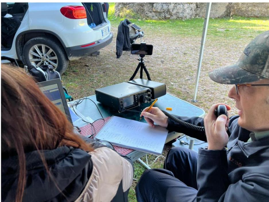
Per la stazione in fonia abbiamo utilizzato la radio FT-991, alimentata da una batteria 12V da 220Ah. Per la registrazione dei QSO, abbiamo sfruttato il software BBLogger opportunamente installato su un PC portatile.
